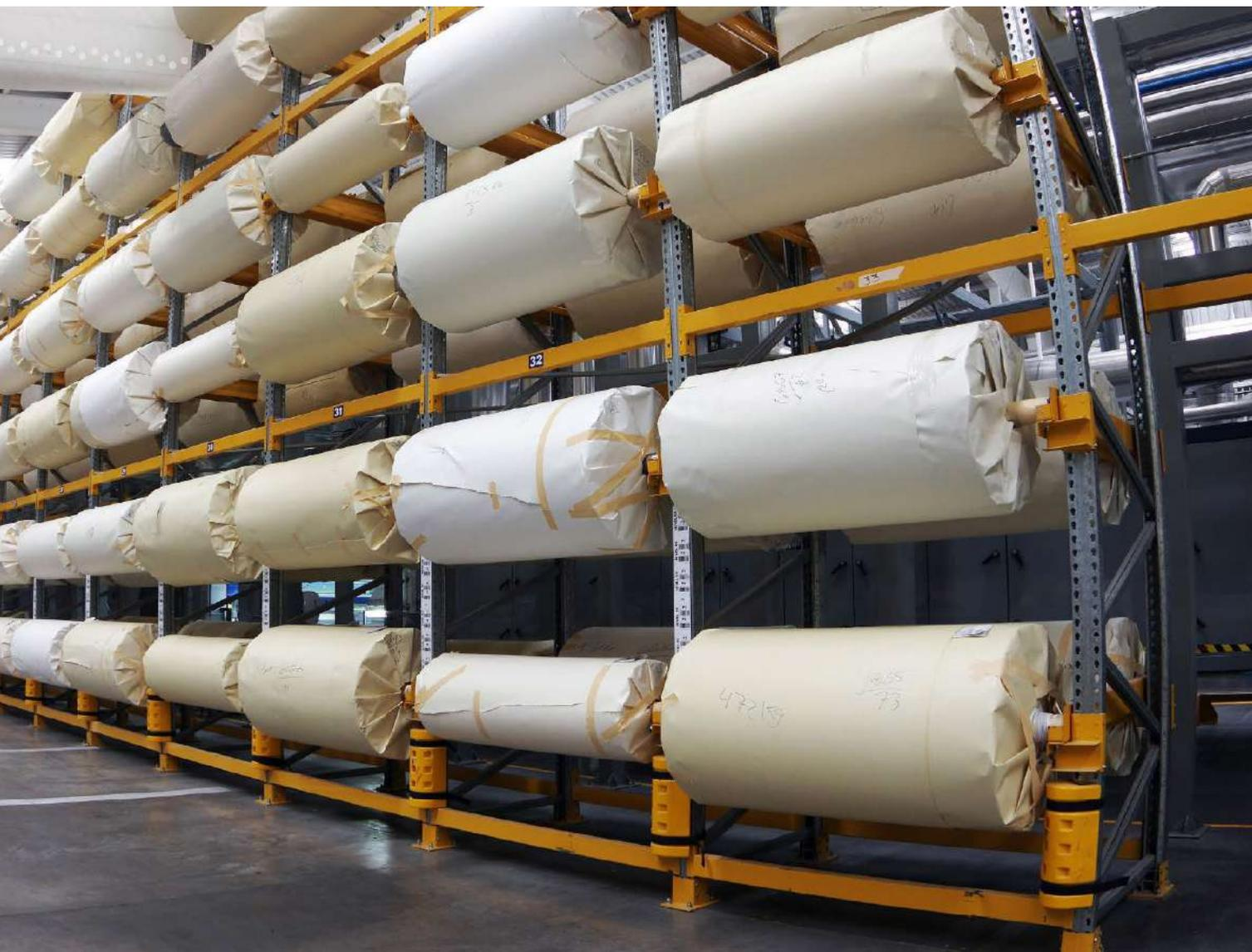
El sistema de MegaRack® Porta Bobinas está diseñado para el almacenaje de elementos cilíndricos (bobinas o rollos), estos se soportan por medio de un eje metálico, el cual se encuentra apoyado en una pieza especial, que le da al sistema la posibilidad de modularlo según las necesidades del cliente.
