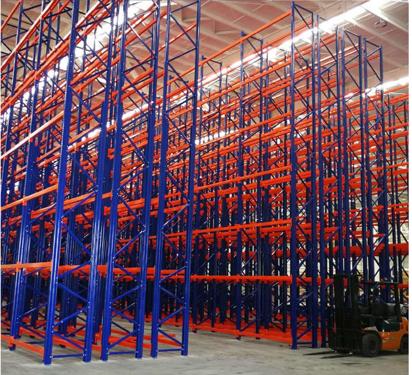
El sistema de MegaRack® Selectivo "Double Deep" se utiliza para el almacenamiento de dos pallets de fondo. Este sistema nos permite obtener el doble de volumen y reduce los espacios de circulación para un mejor aprovechamiento de éstos. Tiene la ventaja sobre un rack selectivo de permitir mayor densidad de pallets y por lo tanto mayor capacidad de almacenamiento, rapidez en el acceso a la segunda tarima de fondo y ahorro de espacio en la bodega al reducir la cantidad de pasillos.
