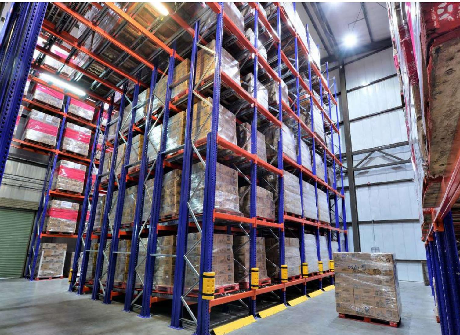
Los sistemas dinámicos MegaRack® consisten de dos elementos fundamentales: una estructura estática y rieles dinámicos, estos rieles se colocan con una leve inclinación a lo largo de todo el sistema permitiéndole a la carga moverse por gravedad o sistema de gravedad del punto de carga (A) al punto de descarga (B) del sistema, los sistemas dinámicos y de frenos pueden incluir controladores de velocidad.
